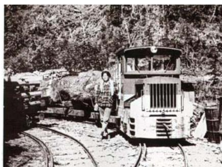
林田山林場的火車頭有蒸氣及汽油引擎兩種，有英國製的蒸氣機關車和日本製的加藤式汽油機關車，台灣光復時，接收 9 輛加藤式汽油機關車，1961 年再增購 5 輛（把老舊的蒸氣火車汰換）之後全是「加藤式」火車的舞台。
