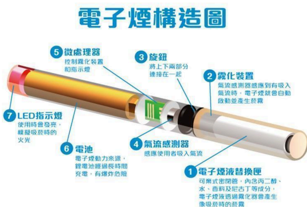
圖1 電子菸構造圖
