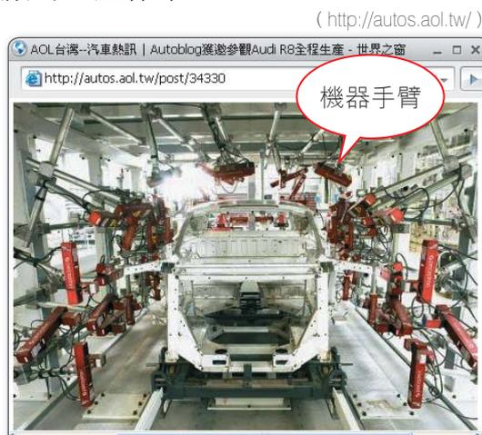
圖2-30 電腦輔助車體製造
